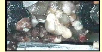
脂肪酸メチルエステル混合軽油 (規格不適合品)による固まり
