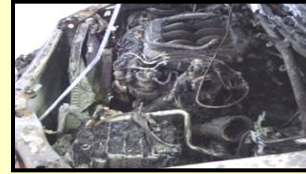
高濃度アルコール含有ガソリン (規格不適合品)による火災事故
