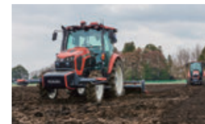
同一ほ場で協調運転する有人機に搭乗して隣接ほ場からロボットトラクターを監視
