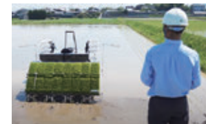
ほ場周囲からロボット田植機を監視
