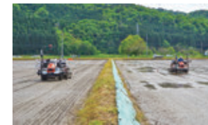
田植機に搭乗してロボット田植機を隣接ほ場から監視
