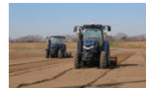
同一ほ場で協調運転する有人機に搭乗して隣接ほ場からロボットトラクターを監視
