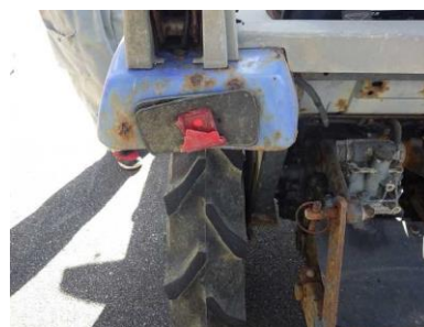
リフレクター破損
