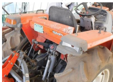
リヤランプ破損
