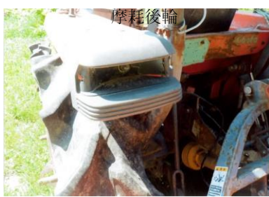
リヤランプ破損
