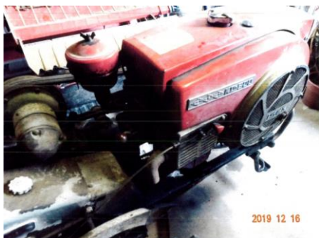
耕うん機 vベルトカバー欠落
