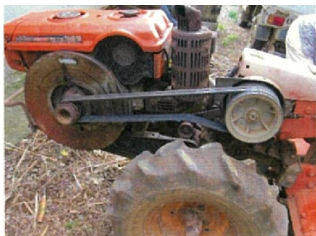
Vベルトカバー欠落
