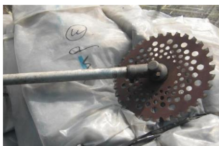
飛散物防護カバー欠落
