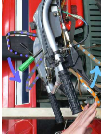
参考図7 挟圧防止装置（耕うん機）
