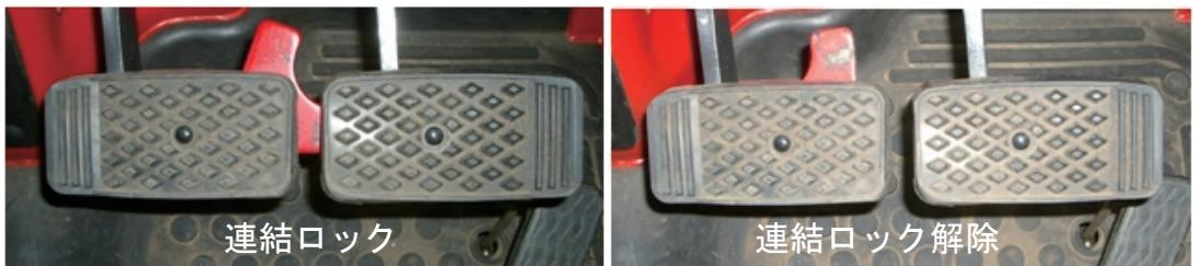
一般的な車輪式の乗用トラクターでは、旋回時に内側の後車輪のみにブレーキをかけて小回りを効かせるため、ブレーキペダルが左右輪で独立しています。しかし、路上走行時にブレーキを片側だけ踏んってしまうと、急旋回を引起して大変危険です。したがって、作業上必要な時以外は、常に左右のブレーキペダルを確実に連結します。
