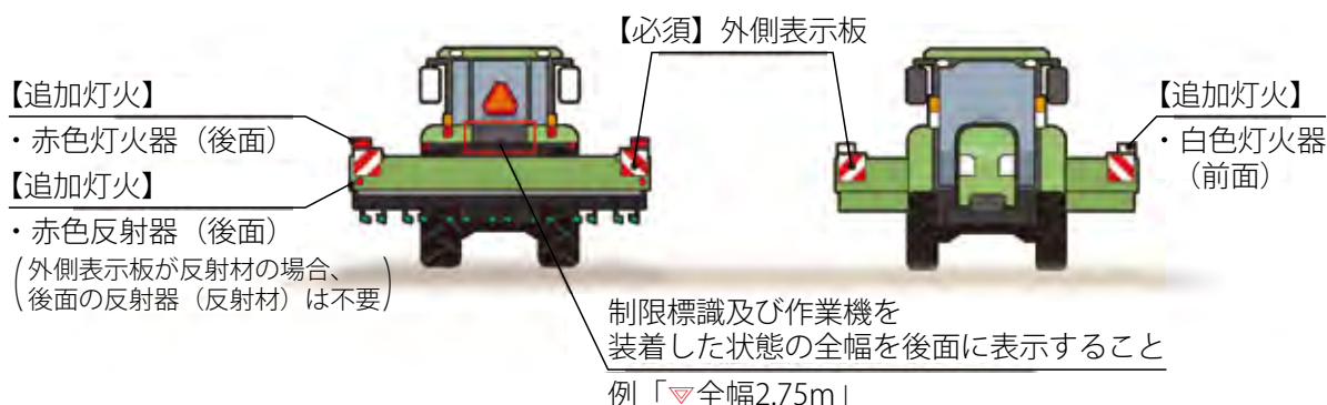
図2-4-5 幅が2.5mを超える場合はゼブラマークと制限標識・全幅の表示
