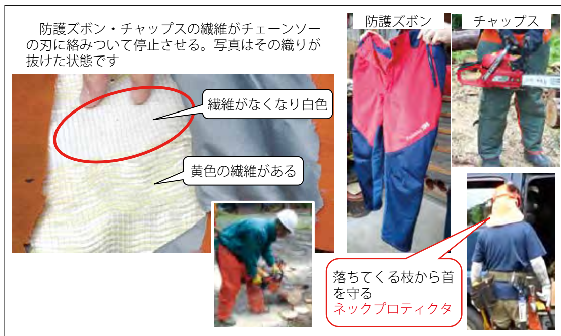
図2-3-6 防護ズボンの繊維がチェーンソーの刃を止める
