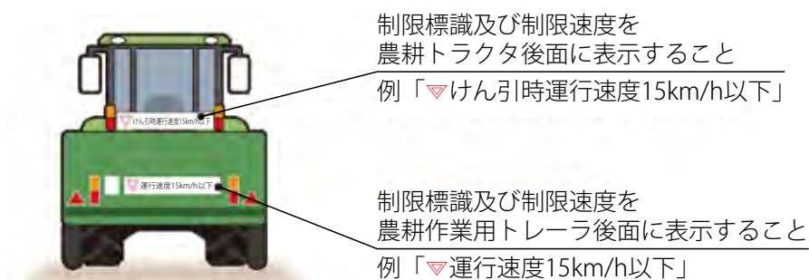
図2-4-7 傾斜角一定以下、ブレーキ未装備トレーラーに必要な表示
