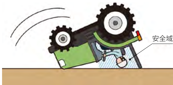
図2-4-9 安全フレームによる安全域
