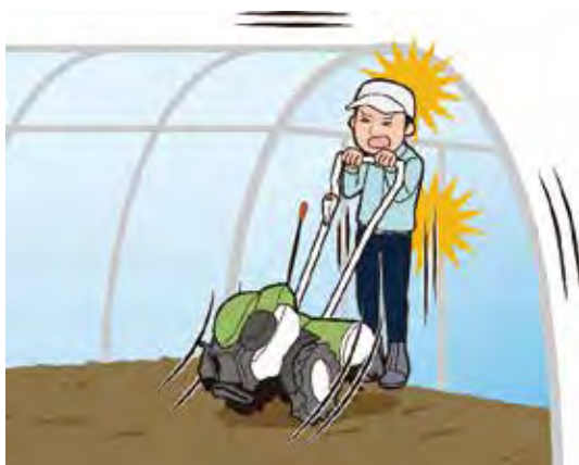
図4-1-3 後退時に支柱等に挟まれる
