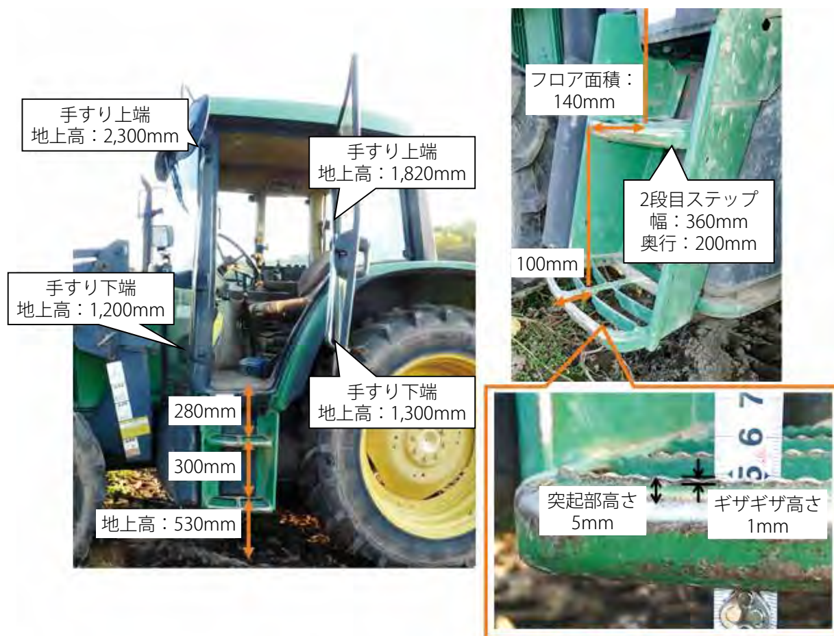
図3-2-17 事故機ステップ、手掛かりの主な寸法
