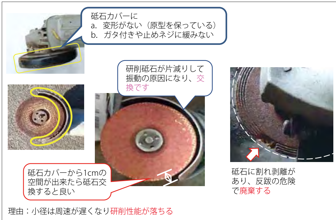
図2-3-20 ディスクグラインダーのカバーと研削砥石
