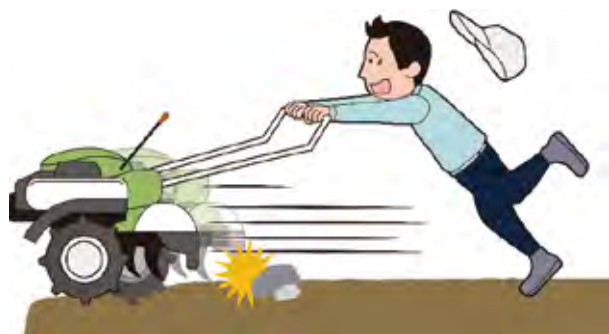
図4-1-4 堅い路面でダッシング
