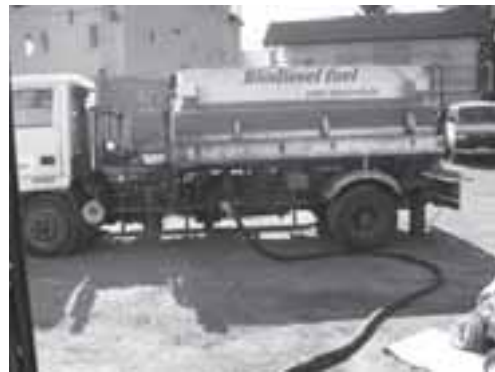
写真 89 バキュームカー （4 t、B.D.F.製造施設へ運ぶ）
