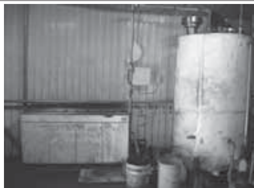
写真 87 ペットボトルを空ける流し台と 1 次貯留タンク（沈殿物を下から抜き取る）
