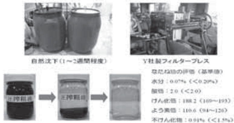
図 15 沈殿・濾過による精製(中央農業総合研究センターバイオマス資源循環研究チーム)
